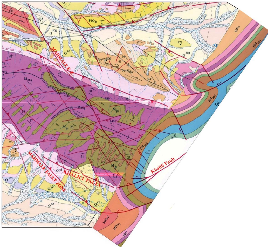
شکل 7 نقشه زمین شناسی و وضعیت هندسه زیر سطحی در تاقدیس تنگ خور و نمایش اثر گسل های محمله و خلیلی در سطح نقشه و در برش زیر سطحی آن
